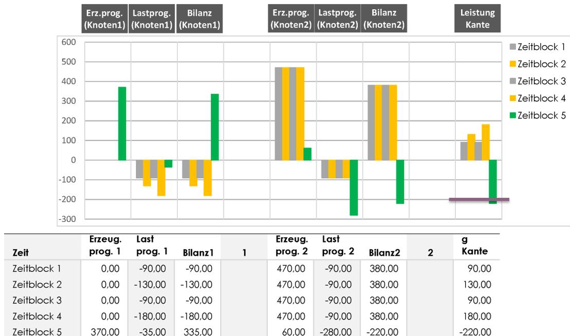
Abb. 2: Leistungsfluss auf Netzverbindung (Kante) zwischen zwei Energiezellen (Knoten)
