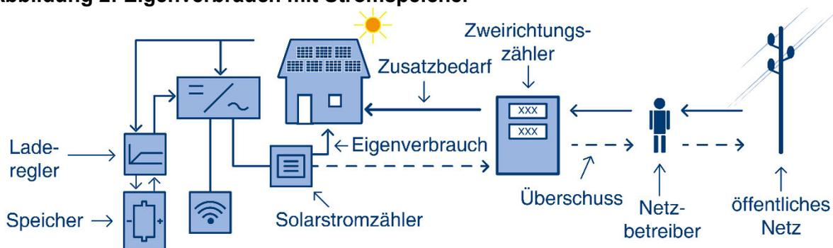
Durch Stromspeicher kann der Eigenverbrauch erhöht werden, sodass weniger Solarstrom abgeregelt und „verschwendet“ wird. Darüber hinaus kann eine Steigerung des Eigenverbrauchs beispielsweise durch Wärmepumpen und Ladestationen für Elektromobile erreicht werden.<sup>60</sup>
