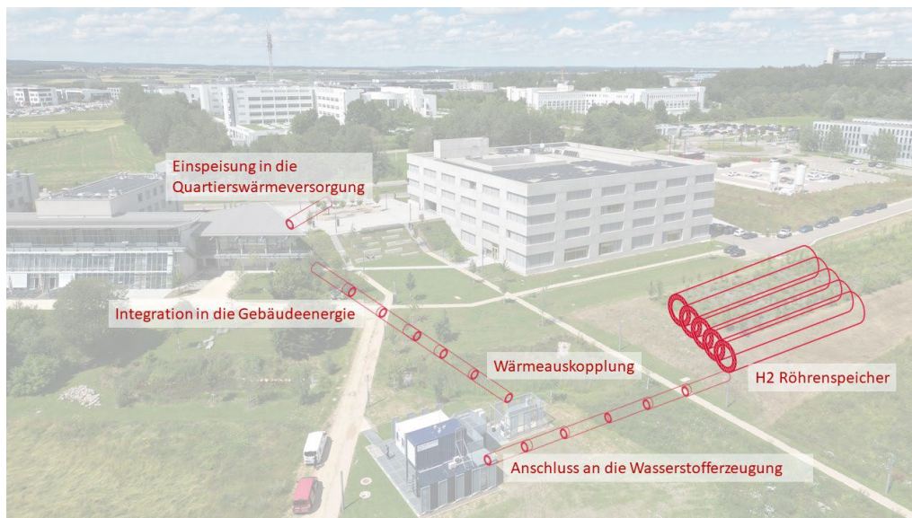
Foto 2: Abbildung Integration H2-Röhrenspeicher in bestehende Infrastruktur am THU-Campus Eselsberg (Quelle: THU)
